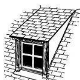
lucarne rampante ou en chien couché
